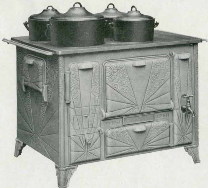
Cuisinière N° 3196, type de campagne représentée à pieds bas, réduisant la hauteur de 6 cm et munie d'un jeu de marmites à degrés. Système d'appel de cendres et de nettoyage par déversement dans le cendrier; trappe de commande sur façade.
